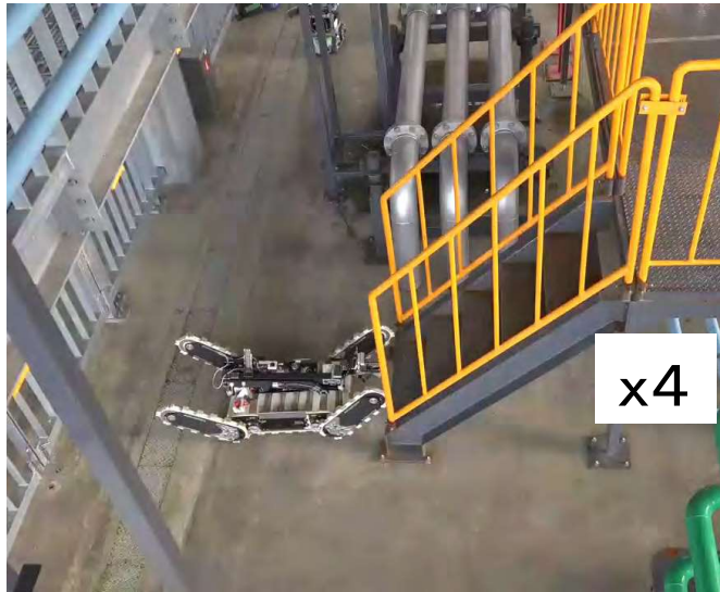
ドローンと小型地上ロボットを併用したゲージ点検
