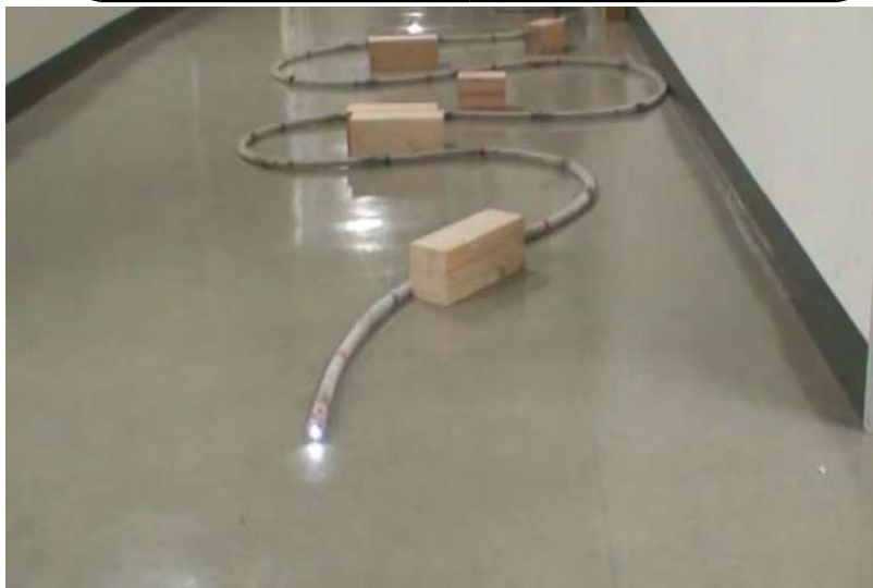
分布型繊毛振動駆動機構による動作
