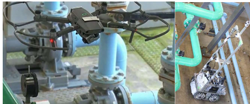
ドローンと小型地上ロボットを併用したゲージ点検
