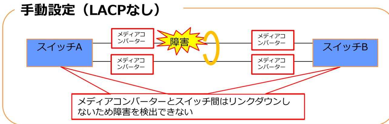
\*スマートミッシングリンク機能は、メタルケーブル側と光ファイバー側ポートの間で、リンク状態を中継する機能です。経路内で発生した障害を接続する機器に自動的に通知します。
